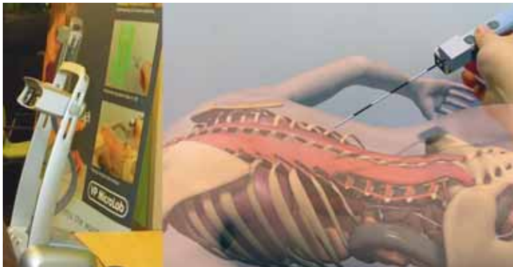
6. Het Microlab-werkstation van Virtual Proteins (links) werkt net als een microscoop, alleen toont het een virtuele werkelijkheid, waarmee allerlei interacties mogelijk zijn. Rechts een voorbeeld van een 3D-model.
