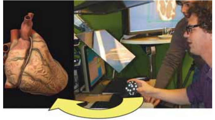
5. Klinisch fysicus M. Sinaasappel test een interactief 3D-werkstation van PS-Tech, waarin een kloppend 3D-hartmodel met de hand 'opgepakt' en naar alle kanten gedraaid kan worden. Tevens kunnen hiermee allerlei doorsnedes worden gevisualiseerd.
