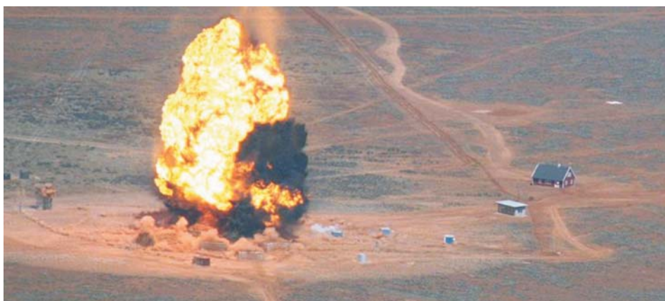
In Australië worden volle-schaalinstrumentatietesten uitgevoerd om veiligheidsafstanden voor explosievenopslag te valideren.
