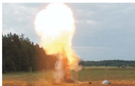
TNO heeft in samenwerking met Dijkstra B.V. een bombestendige prullenbak ontwikkeld en ontworpen. De (meet)resultaten van de experimenten waren doorslaggevend voor het definitieve ontwerp.
