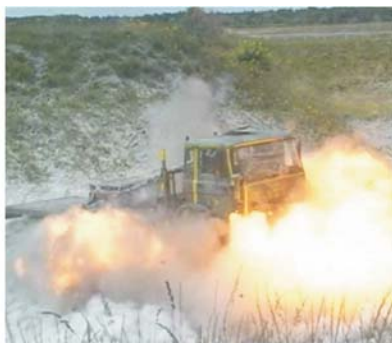
TNO heeft in samenwerking met Dijkstra B.V. een bombestendige prullenbak ontwikkeld en ontworpen. De (meet)resultaten van de experimenten waren doorslaggevend voor het definitieve ontwerp.
