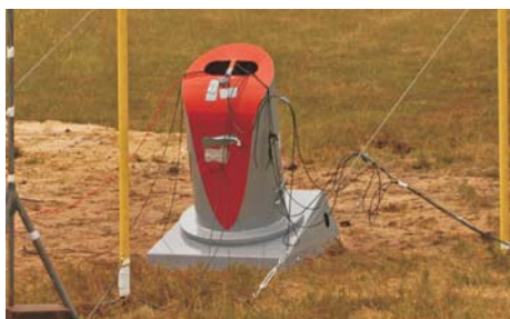
TNO heeft in samenwerking met Dijkstra B.V. een bombestendige prullenbak ontwikkeld en ontworpen. De (meet)resultaten van de experimenten waren doorslaggevend voor het definitieve ontwerp.
