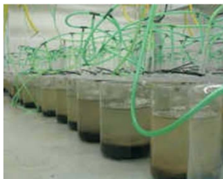
Met een bioassay wordt vastgesteld of een vervuild monster schadelijk is voor het milieu.
