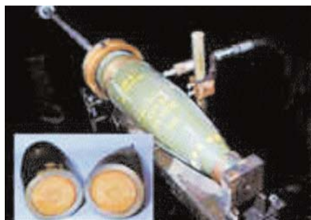
Een projectiel wordt opengesneden met de hoge druk snij- en wateruitspuitinstallatie.
