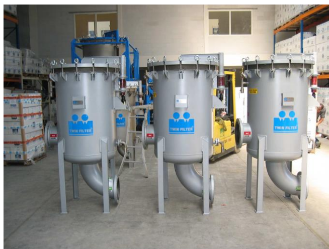
Figuur 8: Modules voor kaarsen of zakkenfilters ( www.twinfiler.com )
