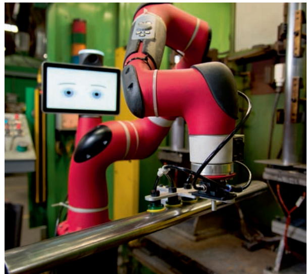
Afbeelding 1. Industriële collaboratieve robot van Rethink Robotics: de Sawyer. De Sawyer is ontwikkeld voor het uitvoeren van precisietaken, zoals het testen van elektronische circuits. Opvallend is dat de Sawyer een 'gezicht' heeft.
