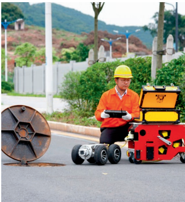
Afbeelding 2. De Schroder s300 riool CCTV pijpspectierobot.
